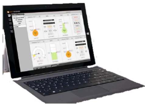
Figura 2 Il software LINERECORDER SMARTOBSERVER per monitorare lo stato di sistemi per il Condition Monitoring e osservare il consumo energetico.
